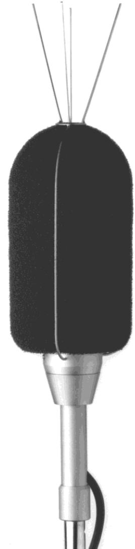
Die wetterfeste Mikrofoneinheit WME 953 besteht aus den Baugruppen Messmikrofonkapsel MK 250 (dauerpolarisiert), Trockenadapter TA 202, Messmikrofonvorverstärker MV 220 P48 mit 5 m XLR – symmetrischen Anschlusskabel, Regenschutz RS 95, Windschutz WS 94 mit Vogelabweisern, mechanischer Halterung mit einem  $\frac{5}{8}$ "- 27 Gang-Gewinde und einem Reduzierstück zur Verbindung mit  $\frac{1}{2}$ " und  $\frac{3}{8}$ "Gewindezapfen.
